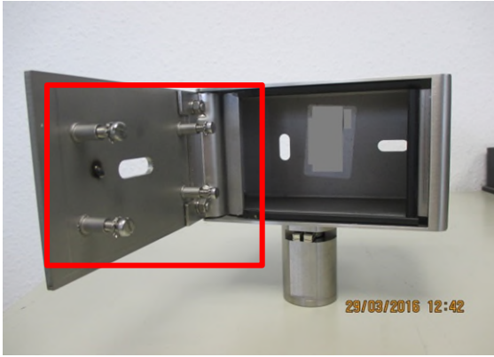
Bild 15: FSD Typ 1 geöffnet, ohne Umstellschloss
