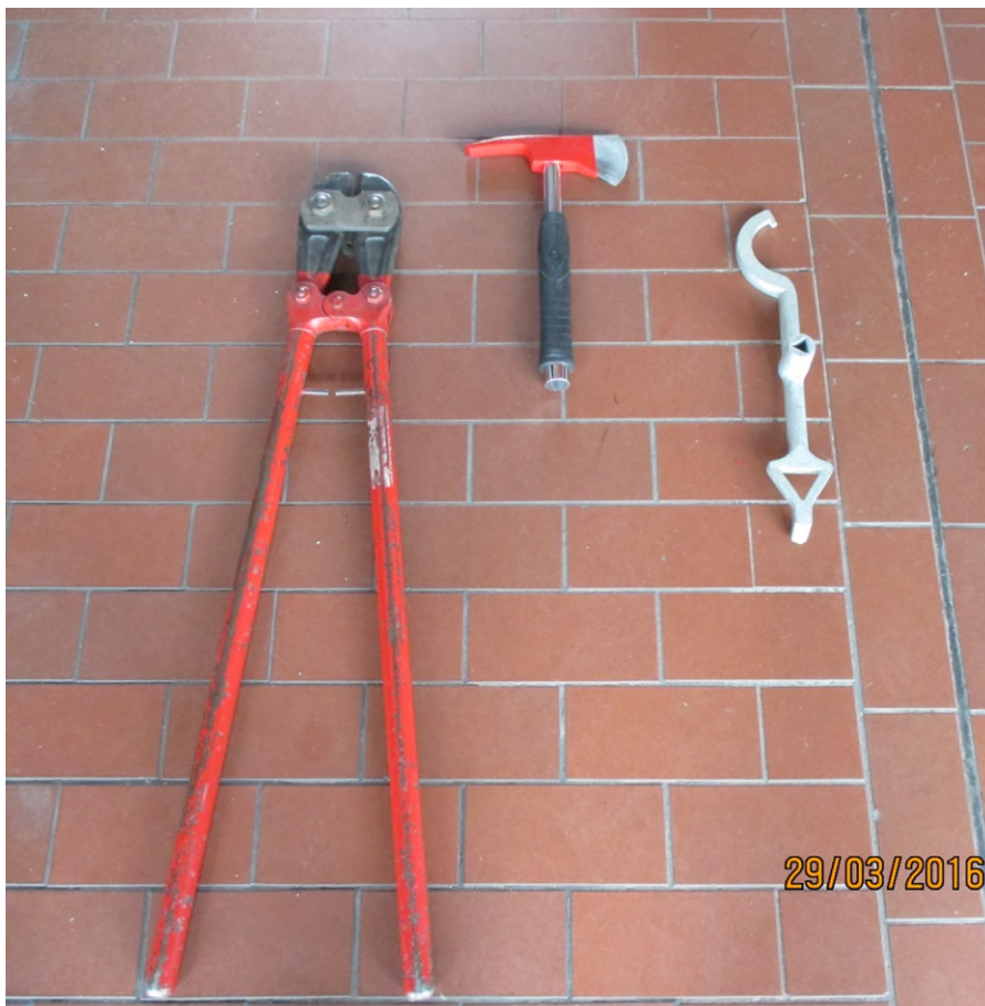
Bild 1: „Schlüssel“ / Öffnungswerkzeuge für zugelassene Sperrvorrichtungen
