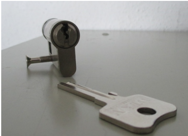
Bild 20: Feuerweherschließung (ugs. FBF-Schließung)
