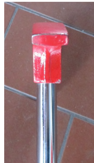
Bild 9: Hebelschneide im Detail - Feuerwehrbeil
