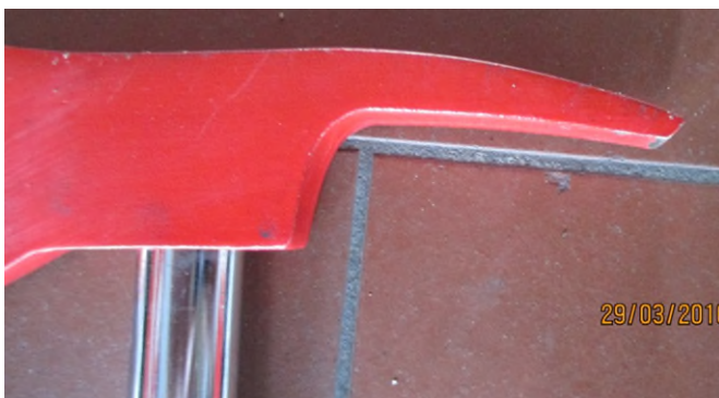
Bild 8: Hebelschneide im Detail - Feuerwehrbeil
